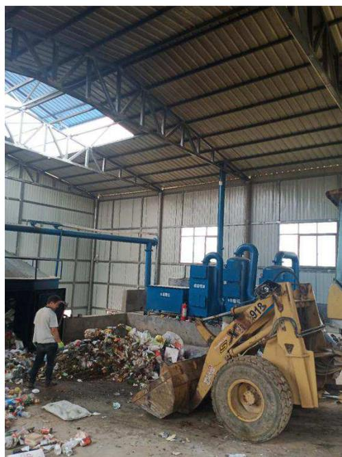
要把不可用于烟气处理的污水抽取喷淋垃圾，保持垃圾湿度，一是可以减少烟气产生，二是可以确保垃圾热解不产生明火。科学资料显示，一般柴草燃烧产生的明火温度只有 600 度左右，而炭火温度可达 800 度以上，而生活垃圾因塑料成份较多，热解产生的温度可达 850 至 1100 度，对环境影响最大的二恶英在 800 度时即可大量降解，当温度达到 850 度以上时可实现全面降解。
