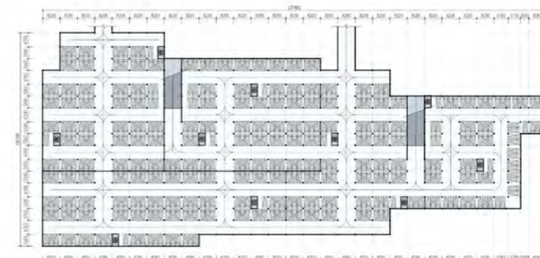
4# 停车库平面图 本层建筑面积 18000m 2 机动车停车位 890 个
