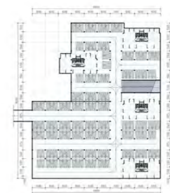
5# 停车库平面图 本层建筑面积 6800m 2 机动车停车位 250 个
